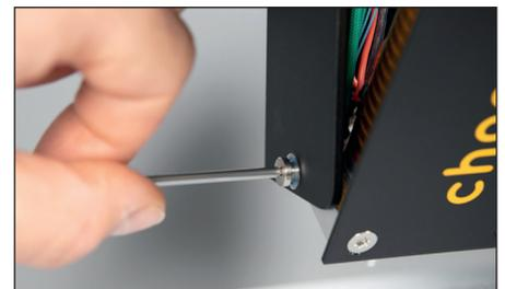
Lockern Sie die Schraube (19) und schieben Sie das Rohr (17) etwas nach oben.
