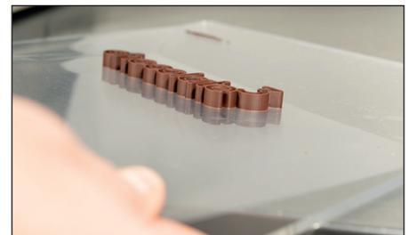
**Hinweis:** Wir empfehlen die Druckobjekte nicht auf dem Druckbett (2) zu entfernen, sondern die Druckauflage (3) zu entnehmen und die Objekte auf einem festen Untergrund zu entfernen.
