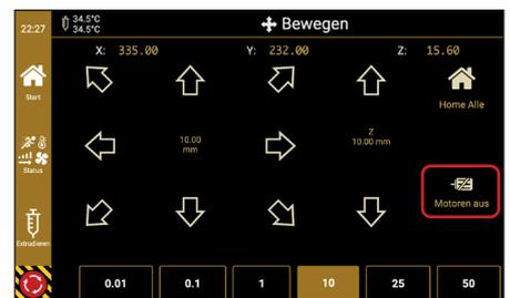
Bewegen Sie den Druckkopf (1) von Hand ganz nach rechts und das Druckbett ganz nach vorne. Drehen Sie an der Z Spindel, bis z.B. ein Blatt Papier genau zwischen Düse und Oberfläche passt.
