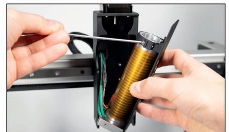
Reinigen Sie alle Teile mit einem feuchten Lappen mit etwas Seife.
