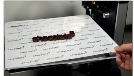
Je nach Umgebungstemperatur benötigt die Schokolade noch 1-10 Minuten um fertig auszukristallisieren. Eine vollständig feste Schokolade ist Grundlage, um die Druckobjekte zu entfernen. Stellen Sie die Druckauflage (3) ggf. kurz an einen kühlen Ort.
