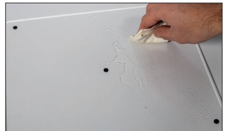
Platzieren Sie eine Folie mittig auf der Druckauflage (3) und streichen Sie diese glatt. Streichen Sie von der Mitte aus möglichst alle Luftblasen heraus.
