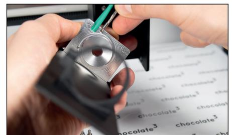
Achten Sie darauf, dass die Kabel des Rohrs (17) in Richtung der restlichen Kabel in der linken hinteren Ecke zeigen.
