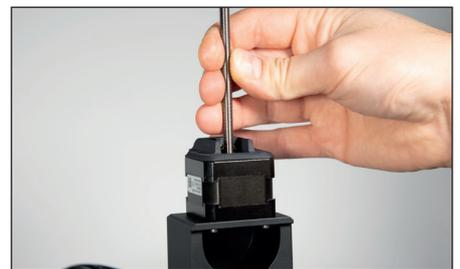
Reinigen Sie die Spindel mit fließendem Wasser, einer Bürste und etwas Seife.
