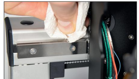
Tragen Sie etwas frisches Fett auf und verteilen Sie es gleichmäßig. Bewegen Sie die Achse 2-3 mal vollständig hin und her. Entfernen Sie anschließend überschüssiges Fett.
