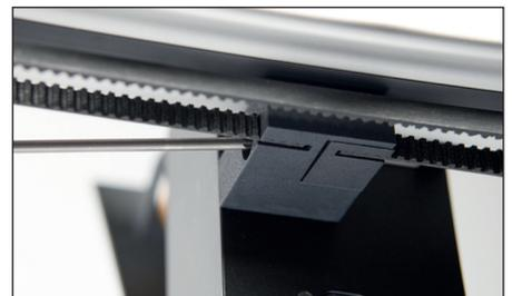
Überprüfen Sie die Spannung der Y-Achse, indem Sie das Druckbett (2) ganz nach vorne bewegen und unten am Riemen zupfen. Er sollte etwas fester sein als die X-Achse.
