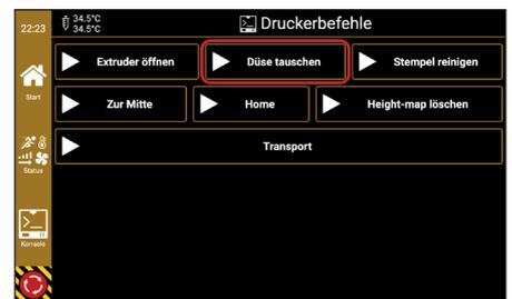
Navigieren Sie zu Quick Actions -> Düse wechseln und folgen sie den angezeigten Schritten.
