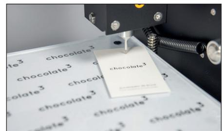
Bewegen Sie das Druckbett (2) vorsichtig ganz nach hinten und überprüfen Sie ob, der Abstand genau wie an Punkt 1 ist. Wenn nicht, Drehen Sie an der Rändelschraube (11), um die Ecke des Druckbetts anzuheben bzw. abzusenken.
