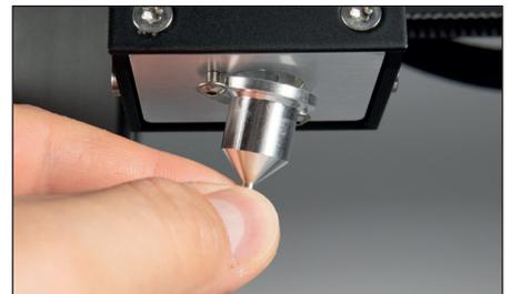
Tauschen Sie die Düse auf der Kartusche durch abschrauben und wieder aufschrauben.
