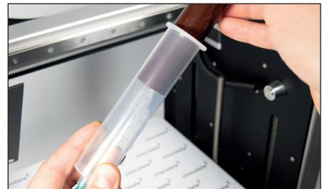
Setzen Sie die so vorbereitete Kartusche in den Druckkopf (1) ein.
