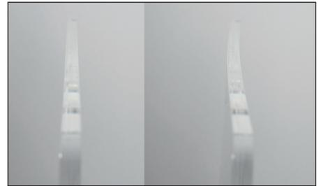
Dies kann einfach korrigiert werden, indem die nach außen gewölbte Seite abgekühlt wird bzw. die nach innen gewölbte Seite erwärmt wird.
