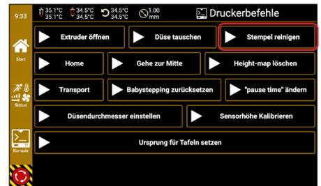
Der Stempel (15) fährt nach oben, sodass der Druckkopf (1) geöffnet werden kann. Im nächsten Schritt fährt der Stempel (15) ein Stück nach unten. So ist er leichter zu erreichen.
