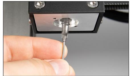
Setzen Sie das passende Düsenelement (14) von unten wieder auf und ziehen Sie die beiden Schrauben (20) fest.
