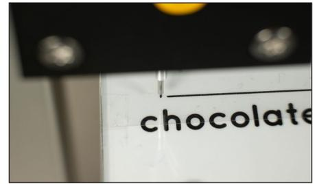
Kalibrieren Sie nun die Höhe des optischen Abstandssensors (10). Befolgen Sie dafür die Anweisungen unter **Home** -> **Quick actions** -> **Sensorhöhe kalibrieren**
