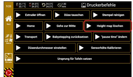
Vor dem „normalen“ 2.5D oder 3D-Druck muss wieder auf die Druckoberfläche referenziert werden.
