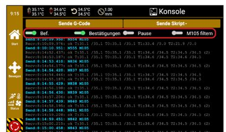
Schaltflächen zum Ein-/Ausblenden bestimmter Befehle und zum Pausieren der Anzeige.
