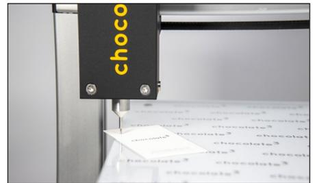
Verstellen Sie ggf. mit der Rändelschraube links den Abstand. Das gesamte Druckbett kippt dadurch nach links bzw. rechts. Wiederholen Sie den Vorgang, bis der Abstand entlang der gesamten Breite des Druckbetts gleich ist.
