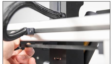
Spannen Sie ihn ggf. durch Drehen der Schraube des Riemenspanners. Es wird ein TX10 Schlüssel benötigt (nicht inklusive).
