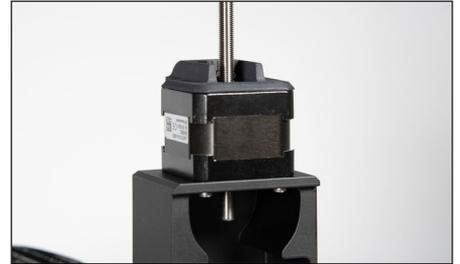
Schrauben Sie die Spindel gegen den Uhrzeigersinn nach oben heraus.
