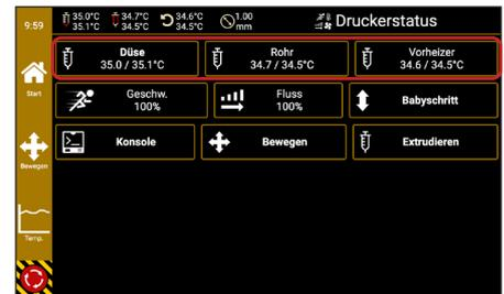
Unter Geschw. kann die Druckgeschwindigkeit in Prozent eingestellt werden, wobei 100% der im .gcode festgelegten Geschwindigkeit entsprechen.
