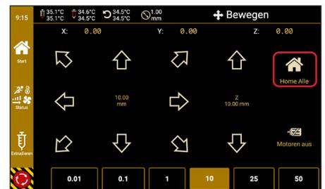
Über die Schaltfläche können alle Motoren Ausgeschaltet werden. Die einzelnen Achsen können nun vorsichtig von Hand bewegt werden.
